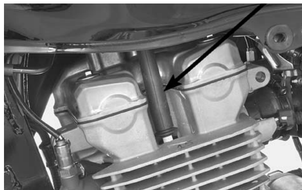
MANGUEIRA DE DRENAGEM DO RESPIRO SUPRESSOR DE RUÍDOS
