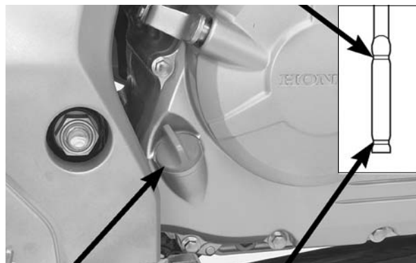
TAMPA DE ABASTECIMENTO DE ÓLEO/VARETA DE MEDIÇÃO
